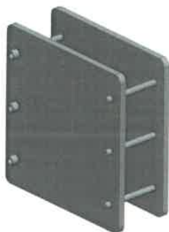
Fig. 1 Diagram of the clamp 图 1 夹具示意图
